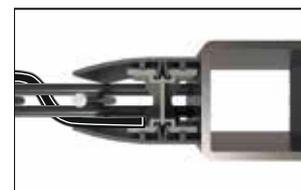
Schlussendlich wird der Sichtschutz in den Torrahmen geflochten. Am jeweiligen Rahmenende wird der Sichtschutzstreifen hinter die montierte Klemmleiste gesteckt.
