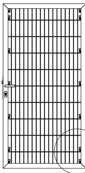
Der MAZUfix-Sichtschutz-Klemmbock wird bis zum Einrasten auf den untersten und obersten Doppelstab der Gittermatte gesteckt. Die restlichen Klemmböcke werden in der Höhe gleichmäßig auf der Gittermatte verteilt.
