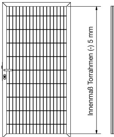
Die MAZUfix-Sichtschutz-Klemmleiste muss für die individuelle Torhöhe zugeschnitten werden.
